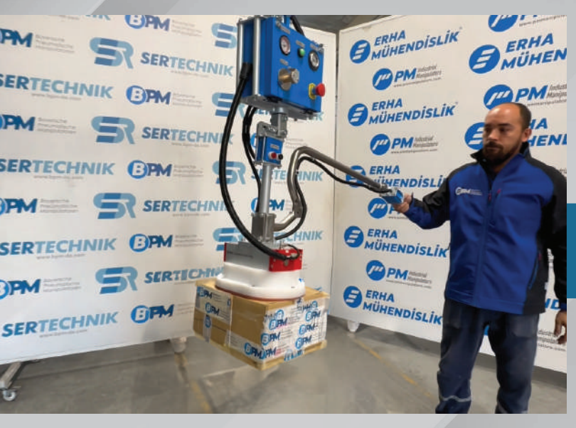
Vacful Box Karton kutular için vakum gripper
