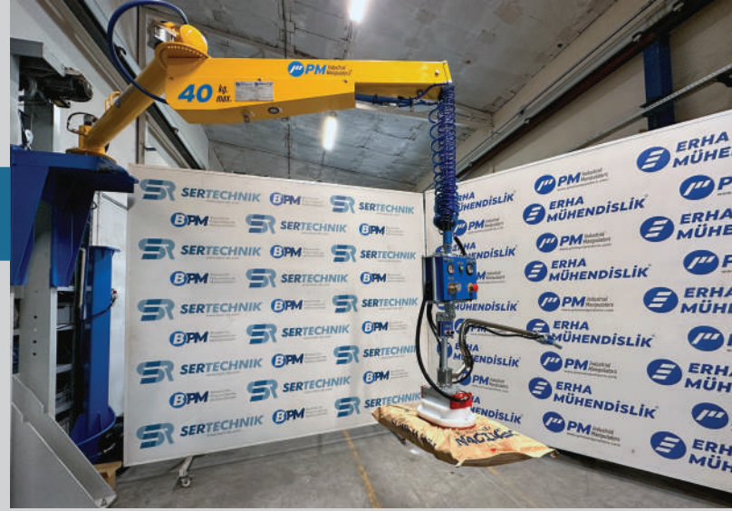
Vacful Bag Torbalar ve çuvallar için vakum gripper
