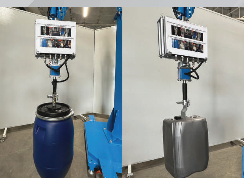
Vacful Multi Varil, fıçı, bidon ve tenekeler için vakum ve mekanik gripper
